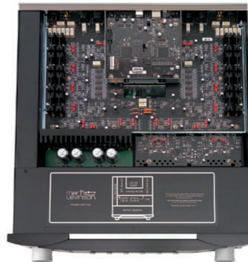
No526 内部構造 左右チャンネルのオーディオ回路をシンメトリカルに配置した デュアルモノラル構成によるフルバランス設計。
